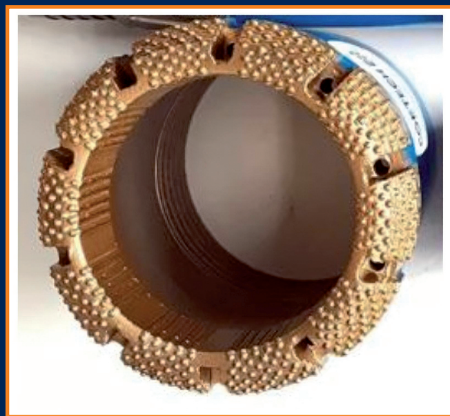
Fig.2 Corona di un utensile diamantato per perforazione [7] Crown of a diamond drilling tool [7]
