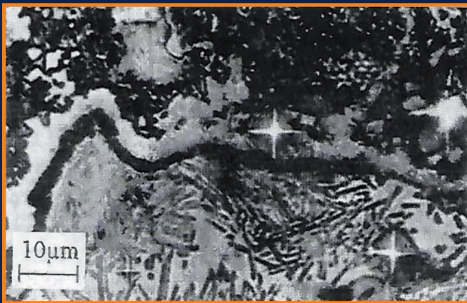
Fig.4 Particella di FTC inclusa in uno strato di interfaccia formato per diffusione dalla lega infiltrante, all'interfaccia con una particella di FTC FTC particle embedded with an interface layer formed by diffusion by the infiltrating alloy, at its interface with a FTC particle
