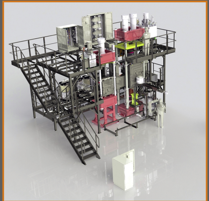
Fig.5 Esempio di dispositivo ibrido GeniCore U-FAST progettato per la produzione di campioni con diametro superiore a 200 mm / Example of GeniCore U-FAST Hybrid device designed for production of samples with diameter above 200 mm
